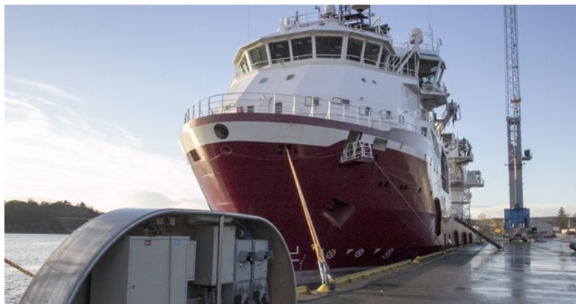
Skipet Dina Star får landstrøm i Kongsgårdbukta i Kristiansand. Foto: Per-Kåre Sandbakk / NRK
